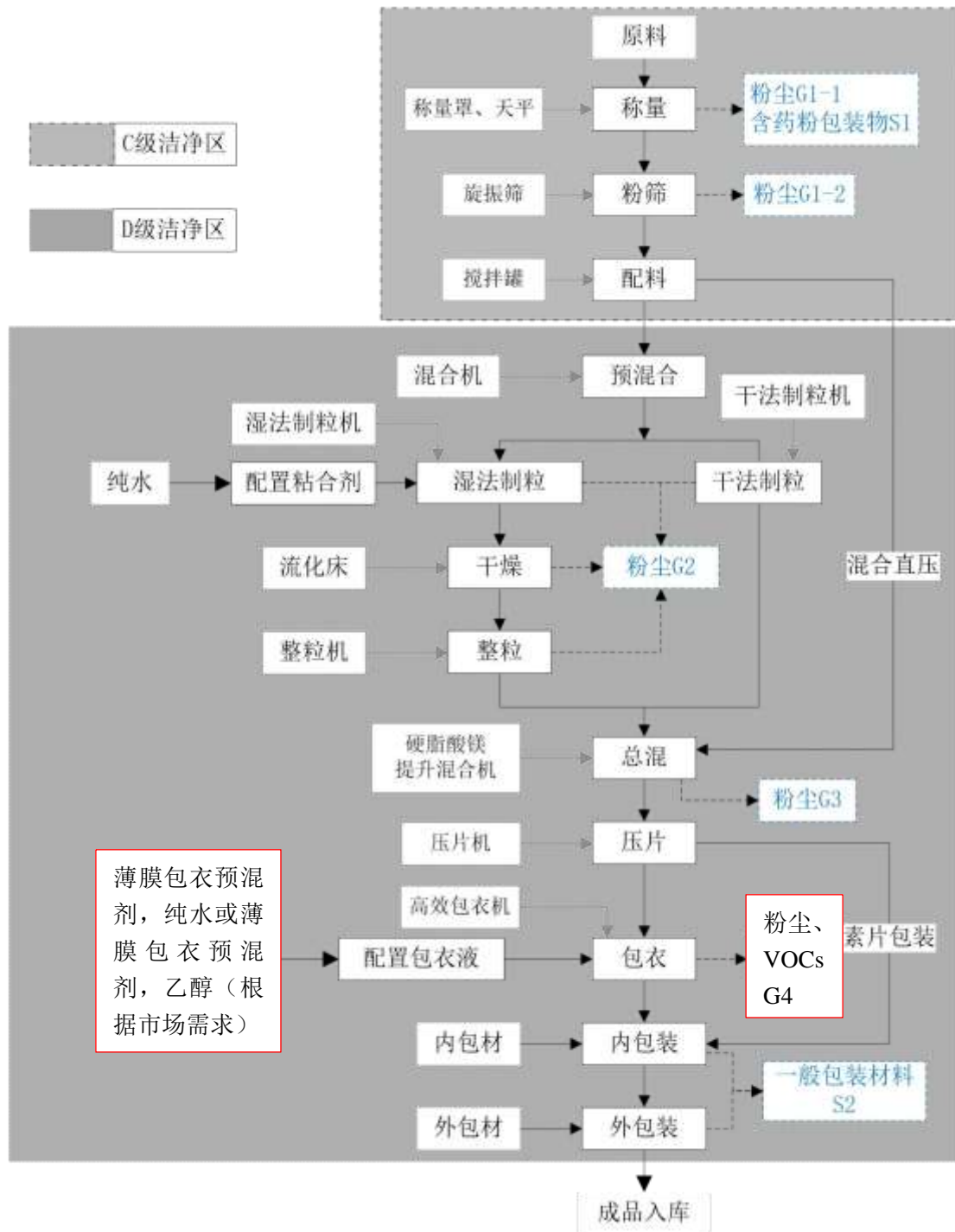
图 1-1 片剂生产工艺流程及产污节点图（变动工序见上图红框）
